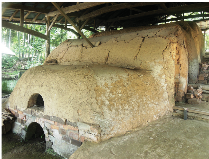
Рис. 1. Японская гончарная склоновая многокамерная печь ноборигама . Фото автора, 2015 г.
